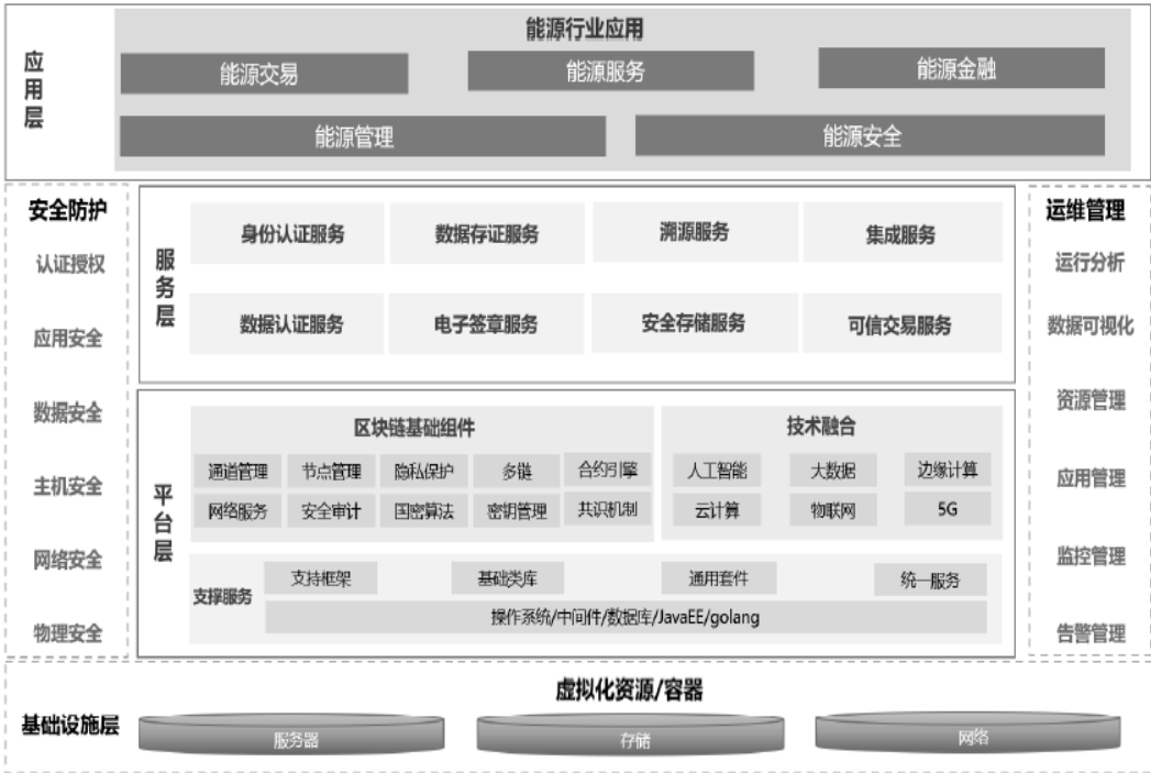
图 7：能源区块链架构
