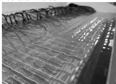
图 6 浸没式单相液冷示意图
