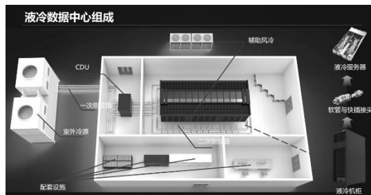
图 11 冷板式液冷数据中心机房整体架构示意图
