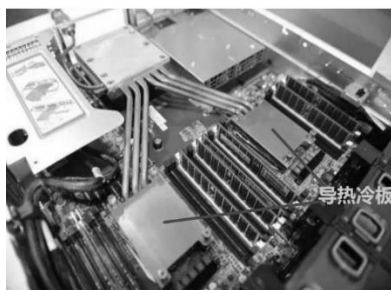
图 4 冷板式液冷技术应用示意图
